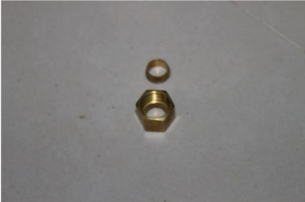
Conforme falamos acima, para fixar a anilha ao tubo de cobre, é necessário apertá-la contra a conexão. Olhe como fizemos nas fotos abaixo:
